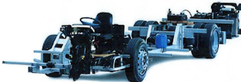
Figura 6: Chassi Mercedes-Benz O 500 U, na forma com é comercialmente encontrado, com motor, transmissão, suspensão, direção e freios, pronto para receber uma cabine.
